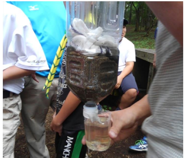
サバイバルということで、手作り浄水器を作成。ペットボトルに砂と木炭と布で作成した浄水器で雨水を濾してみました。うーん。性能は今一つ。
